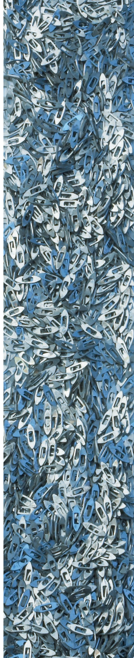
Schüttgut (Textilindustrie) Kohlenstoffstahl FerroChem-behandelt
