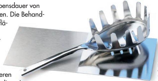
Spaghettizange auf Blech – Edelstahl – elektropoliert, Blech zur Hälfte elektropoliert
