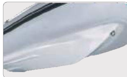
Coque aluminium en V avec renfort anti-ragage sur modèles PVC et Hypalon.
